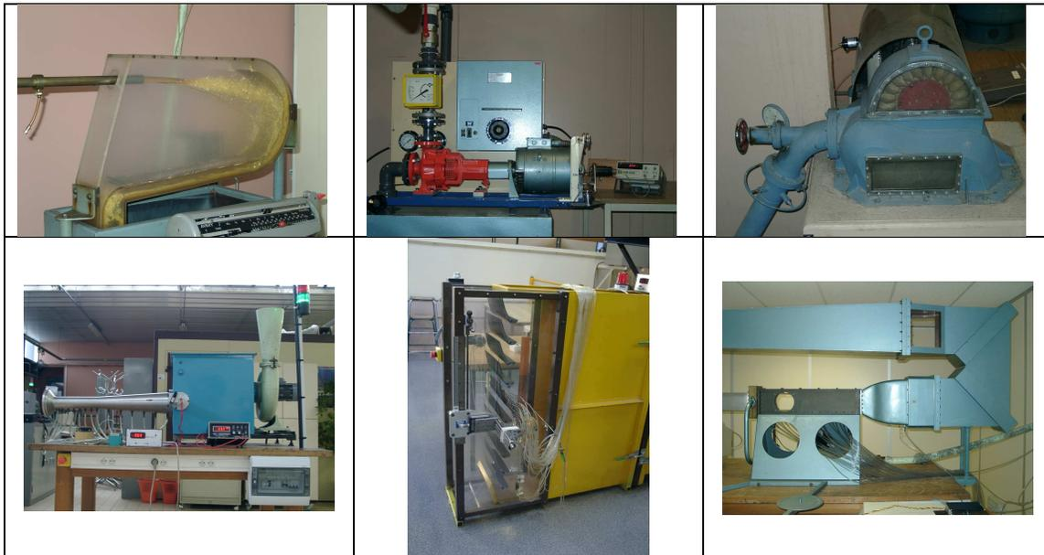
FIG. 1: Quelques-uns des bancs expérimentaux à disposition (de gauche à droite et de haut en bas : conduite à huile, pompe centrifuge, turbine Pelton, banc aéraulique avec diffuseur, grille d'aubes, soufflerie supersonique).
