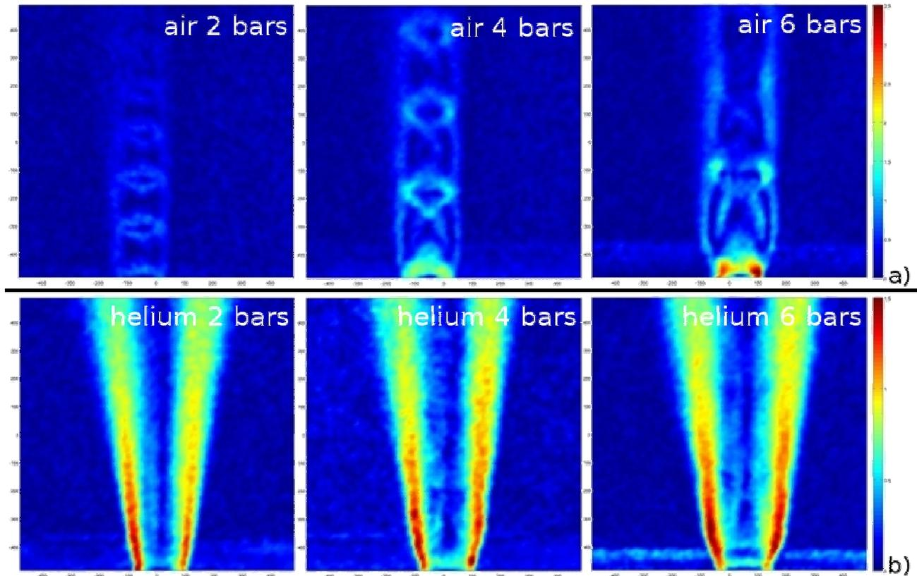
Figure 3 : Cartographies du module du vecteur déplacement pour les jets d'air et d'hélium pour  $2 < P_0 < 6$  bars. a) Cas de l'air, mise en évidence des cellules de choc; b) Cas de l'hélium, évolution de la première cellule de choc et de l'épanouissement du jet.
