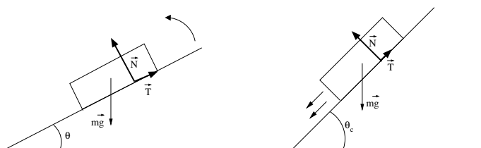
FIG. 4 – La loi de frottement statique de Coulomb a) brique à l'équilibre b) la brique décroche .
