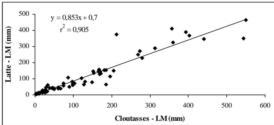
Figure 9 - Relation entre les lames d'eau écoulées mensuelles (LM) des bassins versants de la Latte et des Cloutasses de juillet 1981 à juin 1987.
