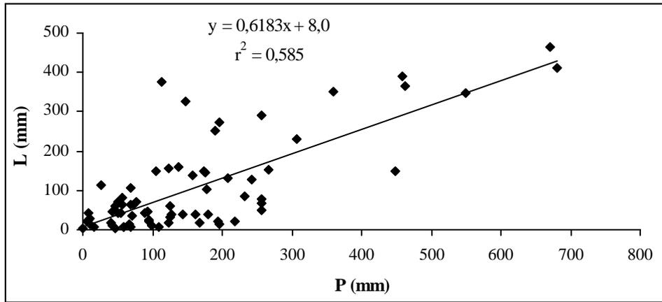
Figure 6 - Relation entre les lames d'eau écoulées (L) et les précipitations (P) mensuelles du bassin versant de la Latte sur la période 1981-87.
