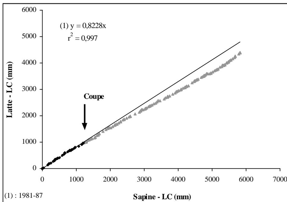
Figure 25 - Double cumulé des lames d'eau écoulées (LC) par les bassins versants de la Latte et de la Sapine les jours où l'écoulement du bassin de la Sapine a dépassé 25,9 mm.
