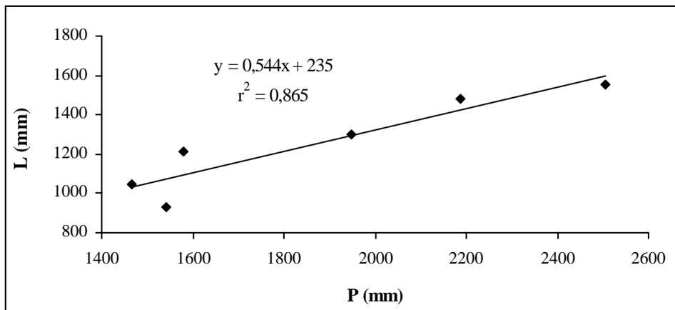
Figure 7 - Relation entre les lames d'eau écoulées (L) et les précipitations (P) annuelles du bassin versant de la Latte sur la période 1981-87.
