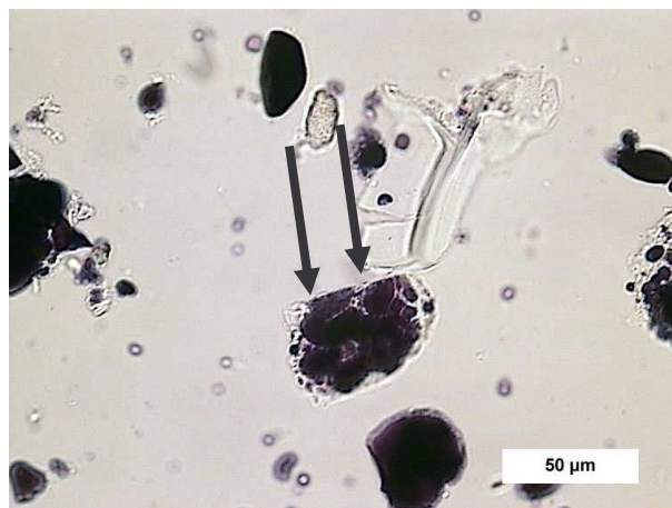
Figure 11 : Grains d'amidon de type B cassés lors de la fragmentation de la cellule (broyage à boulets)
