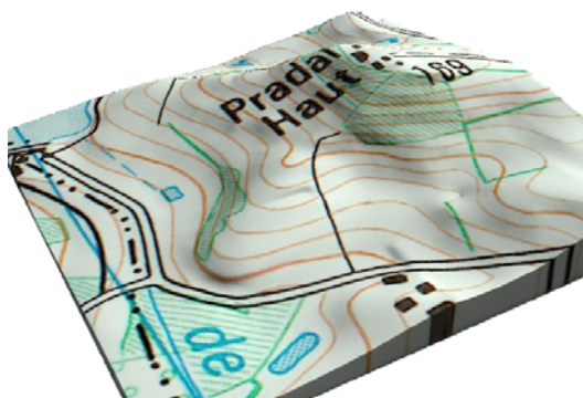
(d) Vue 3D de l'interpolation par RBF et partitionnement de l'unité
