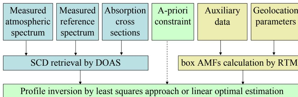
**Fig. 1.** Schematic diagram of the algorithm applied for profile retrieval.[Title Page](#)[Abstract](#)[Introduction](#)[Conclusions](#)[References](#)[Tables](#)[Figures](#)[◀](#)[▶](#)[◀](#)[▶](#)[Back](#)[Close](#)[Full Screen / Esc](#)[Printer-friendly Version](#)[Interactive Discussion](#)
