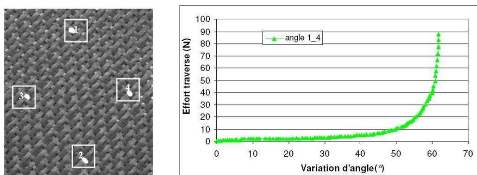
FIG. 4 – Essais de cisaillement au cadre sur un tissu 2.5d ; représentation de l'effort appliqué sur le cadre en fonction de la variation angulaire de la mèche repérée par les marqueurs 1- 4
