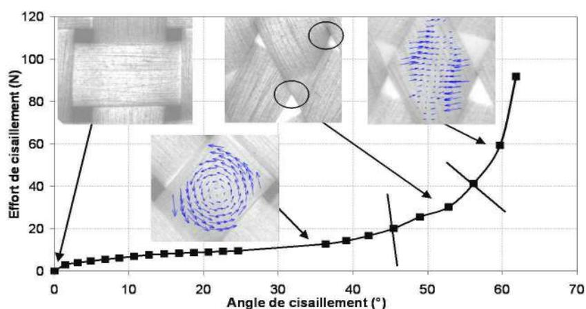
FIG. 3 – Essais de cisaillement au cadre d'un tissu de verre ; mouvement et déformations des mèches au cours de l'essai
