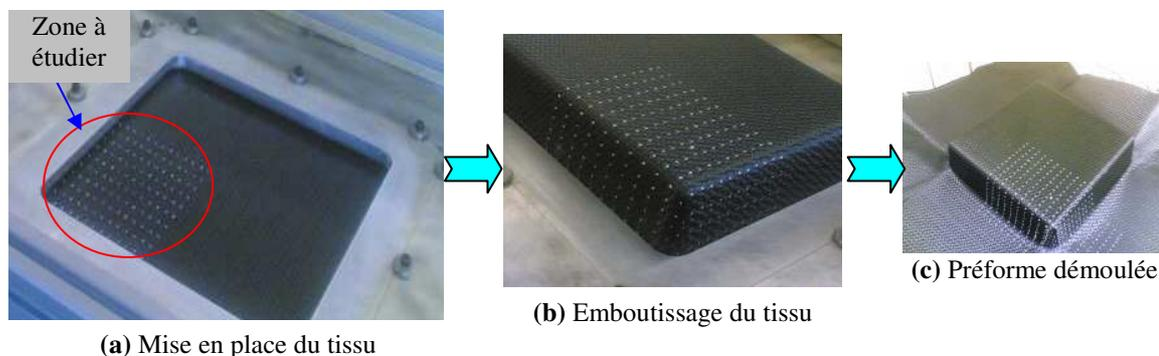
FIG. 5 – Emboutissage d’une préforme carrée en tissu sec.
