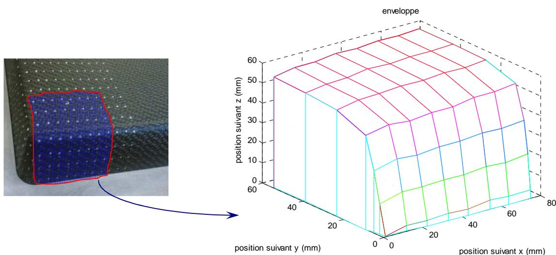
FIG. 6 – Reproduction de la forme 3D du tissu à travers les résultats de l’essai d’emboutissage.
