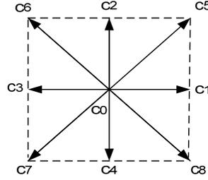
**Figure 1** : Méthode LB : modèle discret D2Q9
