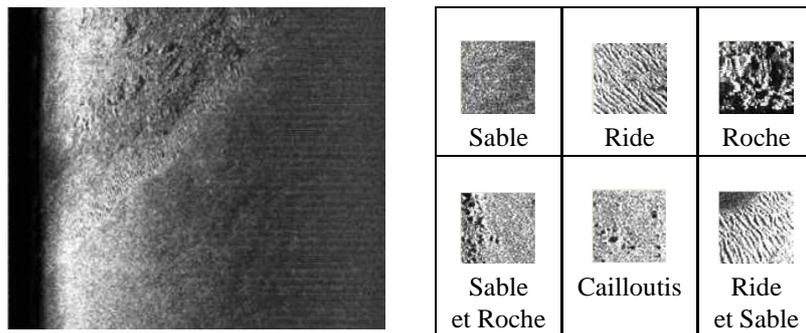
TAB. 1 – Exemple d'image sonar (fournit par le GESMA) et d'imagettes extraites et étiquetées.
