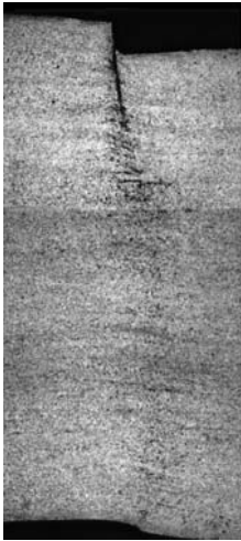
Figure 11 : Micrographie d'une BCA obtenue dans du TA6V (épaisseur : 2 mm)
