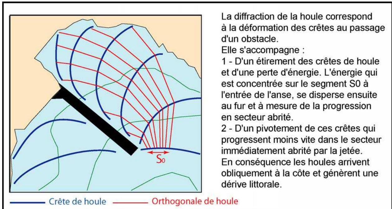
Figure 7 : Conséquences de la construction de la jetée d'IFREMER sur la propagation de la houle dans l'anse de Sainte-Anne.
