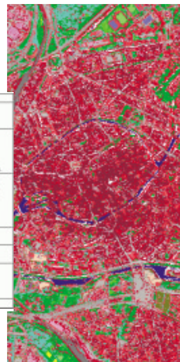
Figure 8 : Classification dirigée par maximum de vraisemblance (Ermapper) avec 24 classes d'intérêt.
