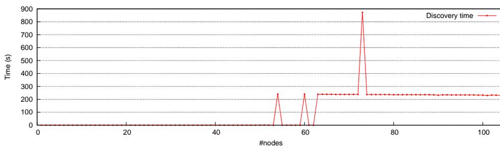
FIG. 7 – Temps de découverte pour l’enregistrement simultané des services de Avahi
