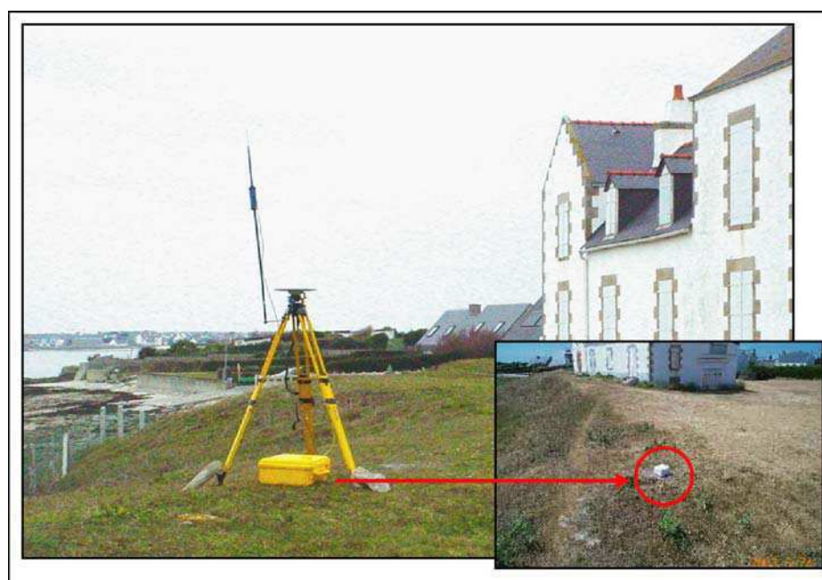
Photo 3 : Base du GPS (station Trimble 5700) mise en station sur la borne IGN
