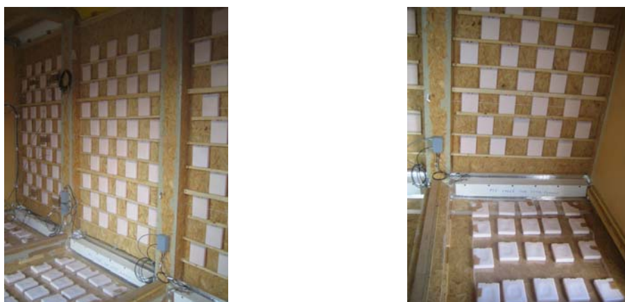
Figure 3: vue intérieure de la cellule test : 30% de la surface est occupée par des MCP pour les trois systèmes (à gauche) et pour un système (à droite).
