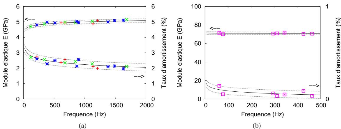
FIG. 2 – Mesure par analyse modale du module élastique  $E$  et du taux d'amortissement  $\xi$ , (a) plusieurs géométries d'éprouvette en PMMA, disque (\* bleu), poutre 300mm  $\times$  30mm (+ rouge) et 400mm  $\times$  30mm (x vert), (b) plaque d'aluminium 7049 de dimension 655mm  $\times$  319mm  $\times$  5mm (carré violet)
