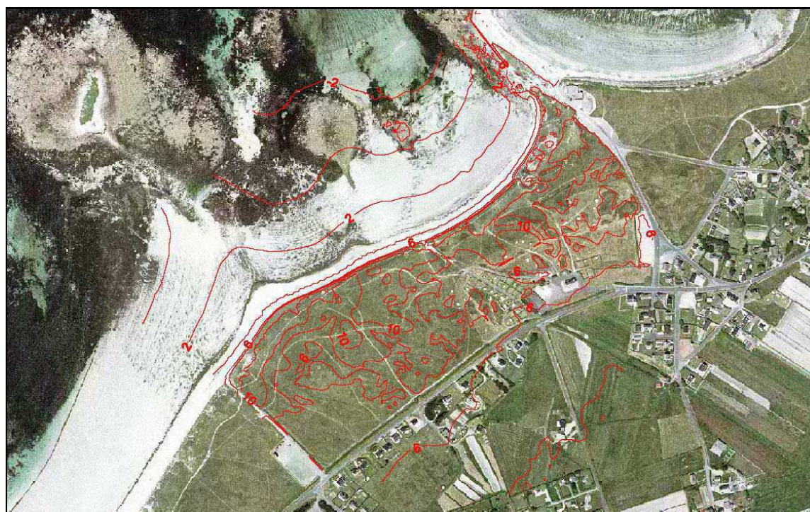
Figure 10 – Superposition de la donnée topographique à l'ortho-photographie IGN de 2000
