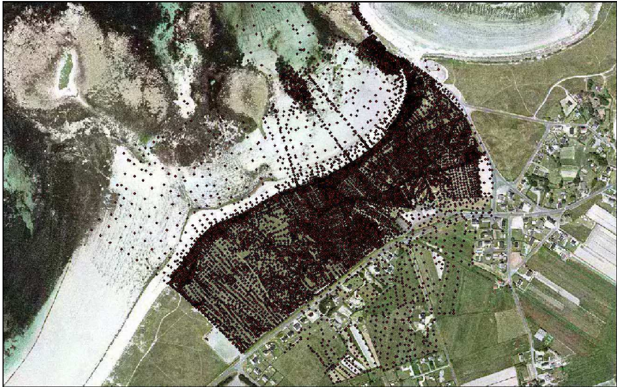
Figure 8 – Distribution spatiale des relevés de terrain ayant servi à la reconstitution topographique du secteur étudié
