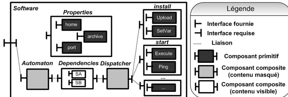
Figure 8. Le composant Software de la machine virtuelle DeployWare
