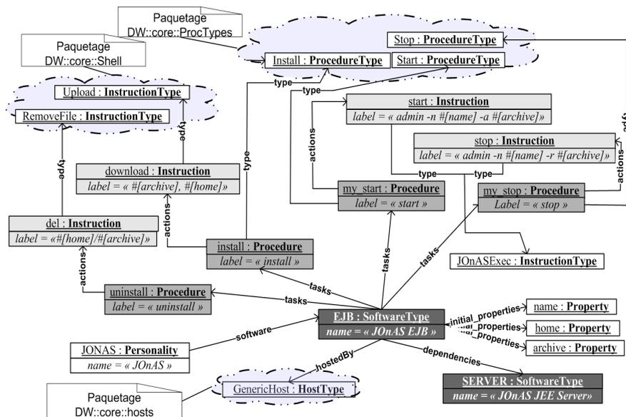
Figure 5. Modélisation de logiciel avec DeployWare : un EJB
