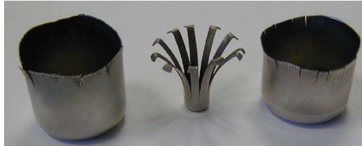
Figure 3. – Casses différées sur godets.
