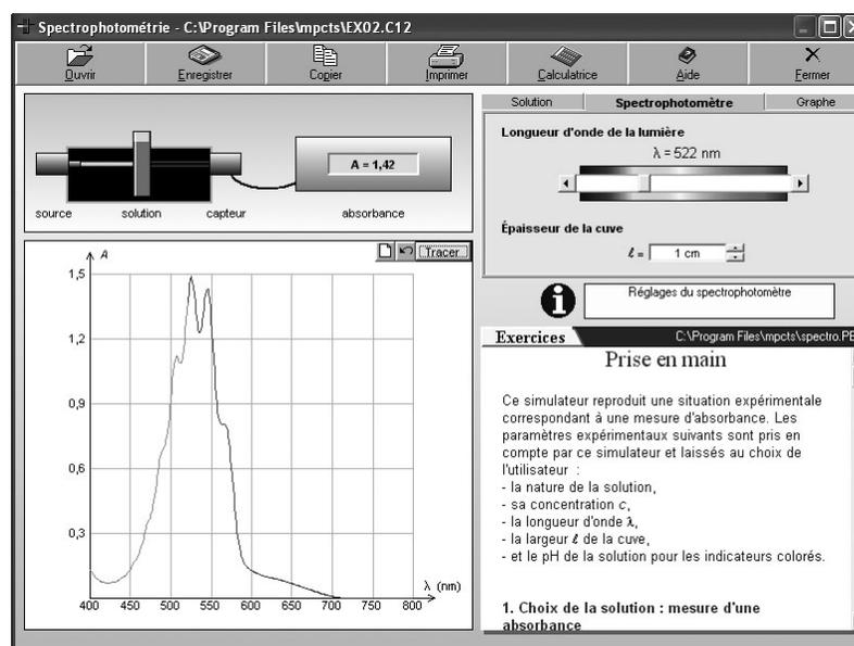
Pour réaliser un tel simulateur, il a fallu déterminer, dans la plage de longueur d'onde considérée (400 – 800 nm), la valeur des coefficients d'absorption molaire des différentes espèces que l'on souhaitait rendre disponibles avec l'interface. La loi de Beer-Lambert supposée vérifiée dans le domaine de concentration autorisé permet de reconstituer tous les spectres possibles.
