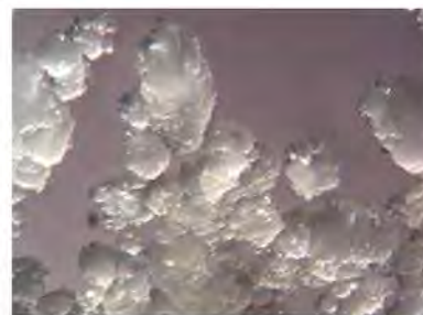
Figure 2 : Aspect du coulis au microscope optique (grossissement facteur 10)
