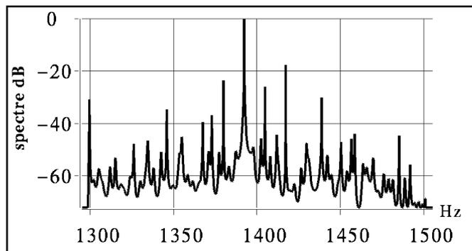
Figure 6 : estimation en dB du spectre par une modélisation AR avec un ordre de 180 sur la sous-bande 1300 Hz-1500 Hz.
