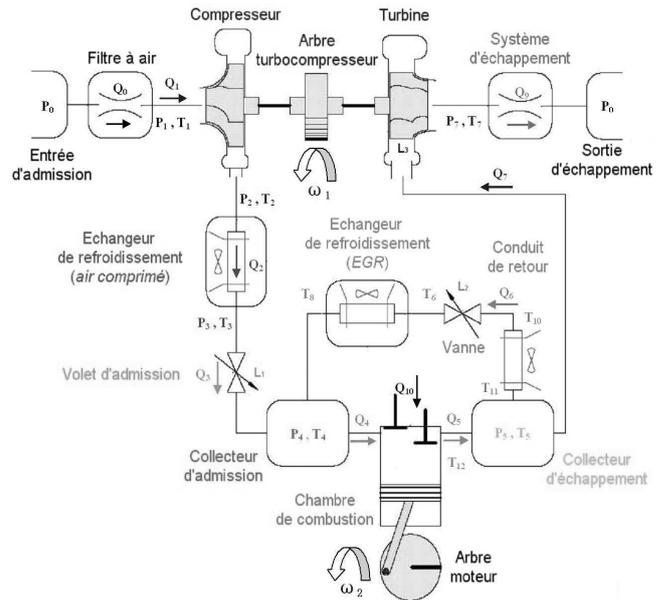
FIG. 2 – Diagramme schématique de la boucle des gaz du moteur diesel DaimlerChrysler OM646.
