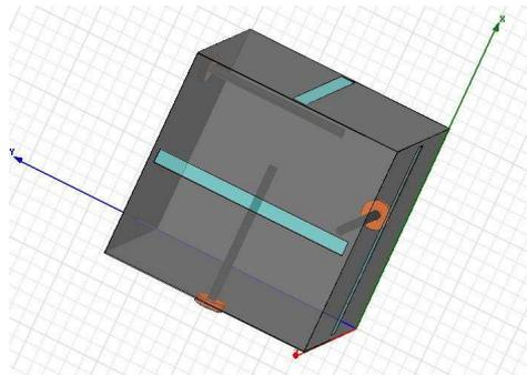
Figure 1 - Système antennaire colocalisé
