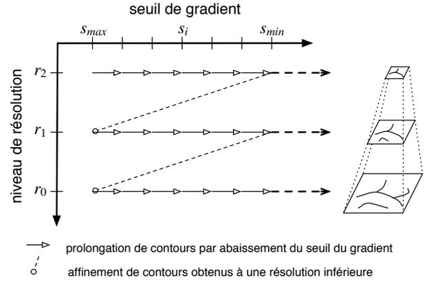
Figure 3 – Schéma d'extraction multirésolution des contours.
