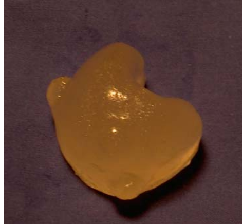
Figure 1: Le fantôme de prostate en gel de bougie
