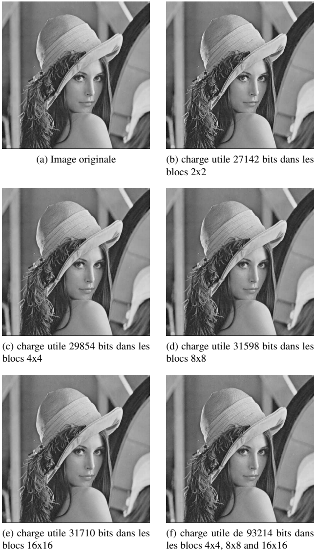
Figure 4: Évaluation de la qualité visuelle après insertion réversible de la charge utile maximale dans l'image leba pour différentes tailles de blocs
