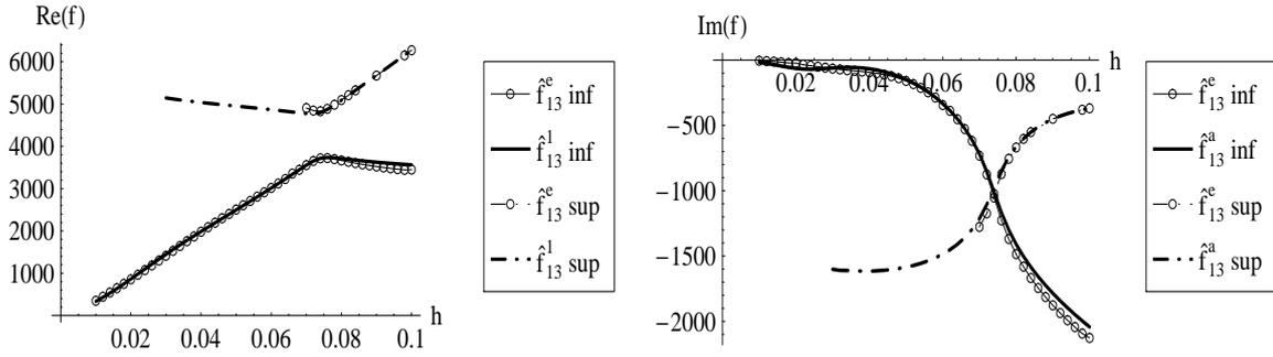
FIG. 1 – Comparaison de la variation en fonction de l'épaisseur des parties réelle (gauche) et imaginaire (droite) de la fréquence du mode de résonance ( $m = 1, n = 3$ ) d'une plaque en acier au contact d'eau calculées par solution exacte (courbes fines accentuées par des cercles) et par développement asymptotique (courbes à traits épais).
