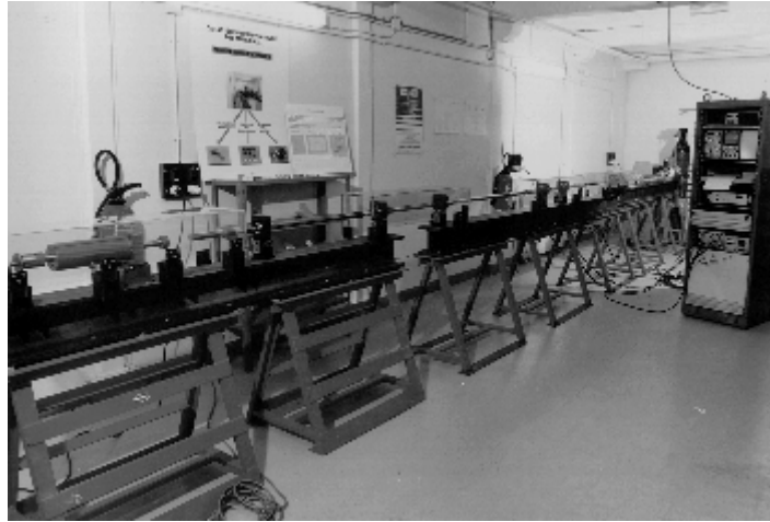
Figure 3 : montage d'essai de compression dynamique de barres de Hopkinson.
