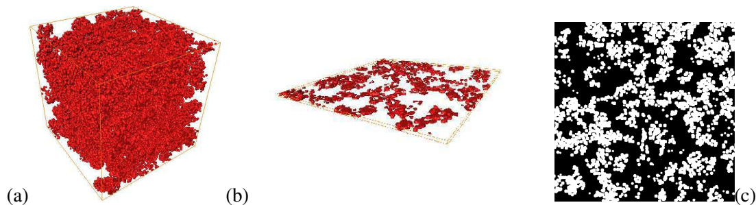
FIG. 4 – (a) : simulation 1600nm de côté - (b) : lame épaisse (40nm) - (c) : cliché MET numérique
