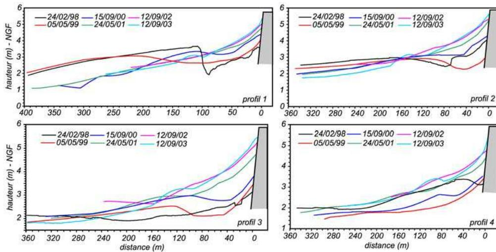
Figure 5. Enveloppes des profils de plages réalisés le long des quatre radiales entre 1998 et 2003.
