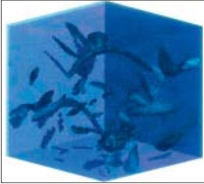
**Figure 1** - Mise en évidence de structures cohérentes obtenues par seuillage de l'intensité du champ de vorticit  dans une simulation num rique directe de l' quation de Navier-Stokes.
