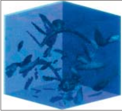
Figure 1 - Mise en évidence de structures cohérentes obtenues par seuillage de l'intensité du champ de vorticité dans une simulation numérique directe de l'équation de Navier-Stokes.
