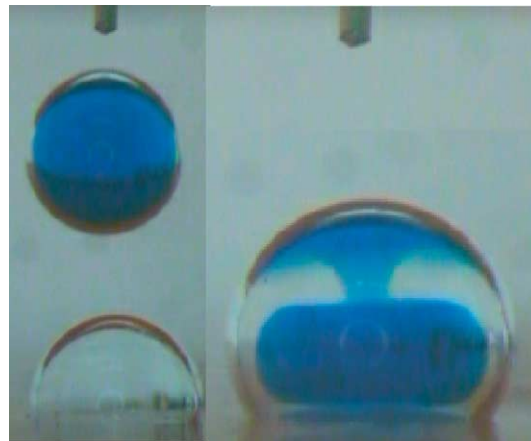
Fig. 7. Les principales étapes, décrites de gauche à droite, de l'encapsulation : (a) goutte « volante » ; (b) état initial du mélange : la structure « champignon ».
