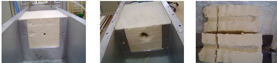
Figure 7. Exemple d'agrandissement du trou durant l'essai d'érosion.
