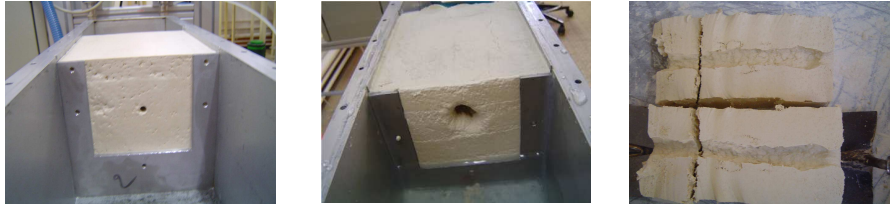
Figure 7. Exemple d'agrandissement du trou durant l'essai d'érosion.
