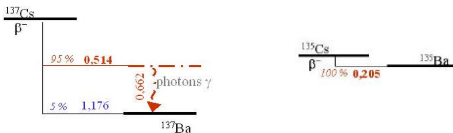
Fig. 1. Schéma de la désintégration des isotopes ^{135}\text{Cs} et ^{137}\text{Cs} présents dans les solutions de produits de fission. Les énergies des différentes particules sont indiquées en MeV (horizontalement pour les particules \beta et verticalement pour les rayons \gamma ). Les pourcentages correspondent à la fraction des particules ayant cette énergie par rapport à la totalité des particules émises à partir d'un niveau d'énergie donné. En traits discontinus sont représentés les niveaux d'énergie des noyaux de baryum Ba excités formés après désintégration \beta du césium et avant émission \gamma .
