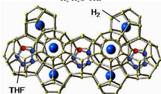
Figure 10 : Représentation structurale du clathrate  $H_2-TBABr-H_2O$
