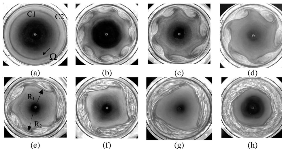
FIG. 2 – (a)  $m=0$ ,  $G=0.0179$ ,  $Re=38998$ ; (b)  $m=8$ ,  $G=0.0179$ ,  $Re=51313$ ; (c)  $m=7$ ,  $G=0.0286$ ,  $Re=43101$ ; (d)  $m=6$ ,  $G=0.0429$ ,  $Re=34893$ , (e)  $m=5$ ,  $G=0.0429$ ,  $Re=45155$ , (f)  $m=4$ ,  $G=0.0429$ ,  $Re=61575$ , (g)  $m=3$ ,  $G=0.0714$ ,  $Re=49260$ , (h)  $m=0$ ,  $G=0.0714$ ,  $Re=102625$ .
