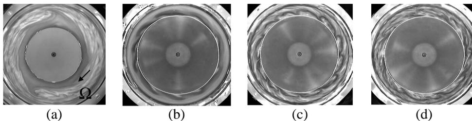
FIG. 5 – (a) Mode  $m=2$  pour  $s=0.536$ ,  $G=0.0714$  et  $Re=41050$  (spin-down). Instabilité sur le cylindre intérieur pour  $s=0.75$ ,  $G=0.0714$  (spin-up) : (b)  $Re=10263$ , (c)  $Re=24630$ , (d)  $Re=34893$ .
