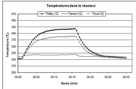
Figure 3 : Chauffage du lit filtrant sous rayonnement micro-onde
