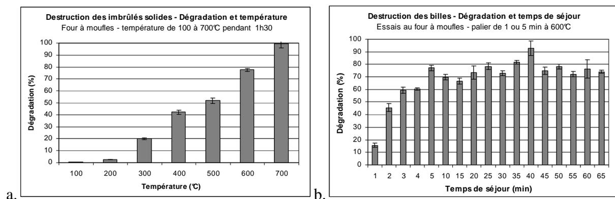
Figure 1 : Oxydation des imbrûlés dans le four à mouffles : a- en fonction de la température, b- en fonction du temps de séjour pour  $T=600^{\circ}\text{C}$
