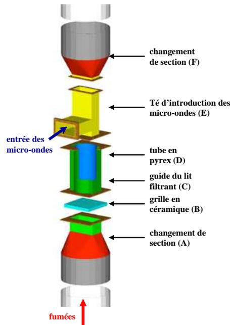
Figure 2 : Dispositif de régénération sous irradiation micro-onde
