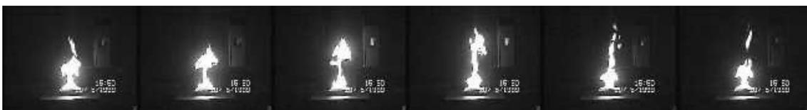
Figure 1 : séquence vidéo issue de l'observation d'une flamme d'acétone à 10 m (mode pulsant)
