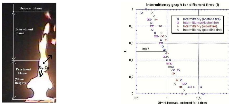
Figure 2a et 2b : flamme de diffusion et graphe d'intermittence pour plusieurs feux : Acétone, Alcool, bois, essence A
