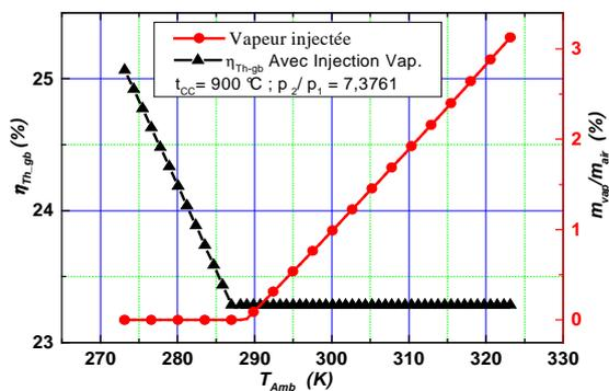
Figure 7 : Rendement et le rapport (vapeur-air) injecté.
