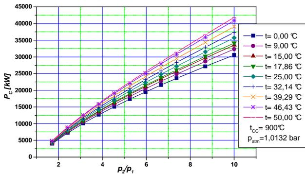
Figure 3 : Puissance absorbée par le compresseur.
