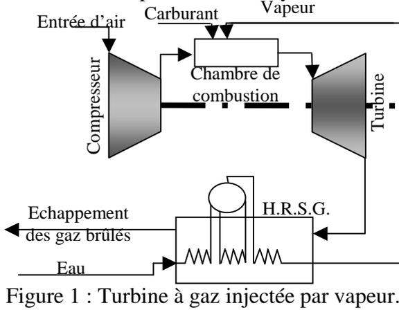
Figure 1 : Turbine à gaz injectée par vapeur.
