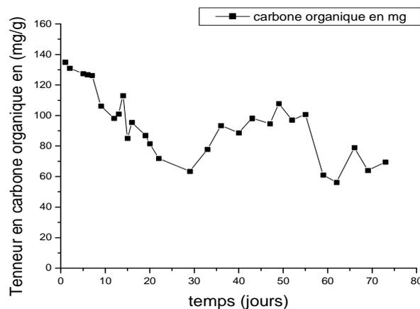
Figure 3 : évolution du carbone durant la biométhanisation
