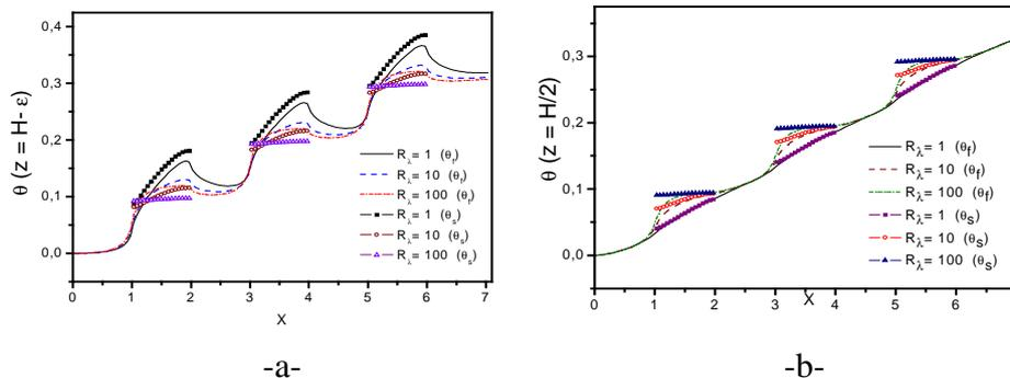
Figure 5 : Profils des températures solide et fluide près de la paroi supérieure (a) et au plan médian (AA') (b) pour  $R_s = 100$ ,  $Da = 10^{-4}$ ,  $Re = 10$ ,  $Ra = 10^4$  et pour différentes valeurs de rapport de conductivité  $R_\lambda = 1, 10, 100$ .
