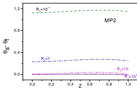
Figure 3 : Différences de températures des particules solides et fluide sur le plan vertical (BB') pour  $Da = 10^{-4}$ ,  $Re = 10$ ,  $Ra = 10^4$ ,  $R_\lambda = 10$  et pour différentes valeurs de  $R_s$ .
