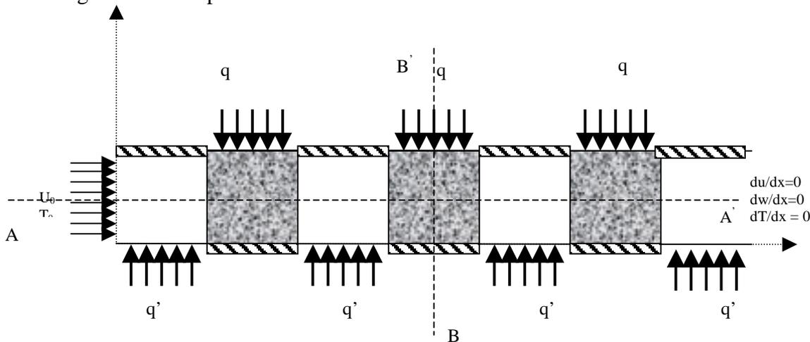
Figure 1: Configuration géométrique et conditions aux limites.
