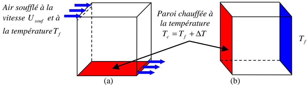
Figure 1 : cavité ventilée(a) et cavité fermée(b)
