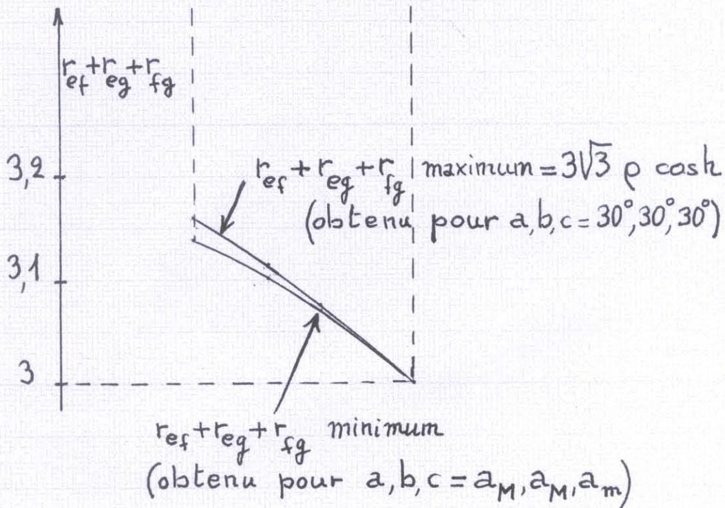
Figure 19. Pour  $\rho = 0,63$  et en fonction de l'angle  $h$ , le minimum et le maximum des fonctions  $\Delta(\rho, h, a, b, c)$  et  $r_{ef} + r_{eg} + r_{fg}$
