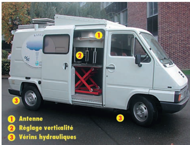
Figure 2 - Version au sol du radar Rasta de Rali. L'ensemble radar-système d'acquisition-micro-ordinateur de visualisation est installé dans ce camion Renault Master, dont la structure a été modifiée pour permettre l'installation de l'antenne du radar.
