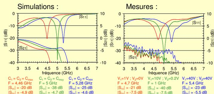
Simulation de l'adaptation en fonction de la charge complexe  $Z_{out}$  :
