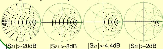
Influence de la résistance série des diodes sur les charges complexes adaptables ( $|S_{11}| < -20$  dB et  $|S_{21}| > -2$  dB) :
