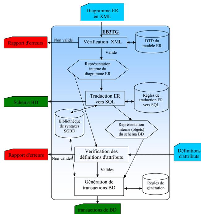
FIG. 2 – Architecture fonctionnelle de l'outil EB<sup>3</sup>TG
